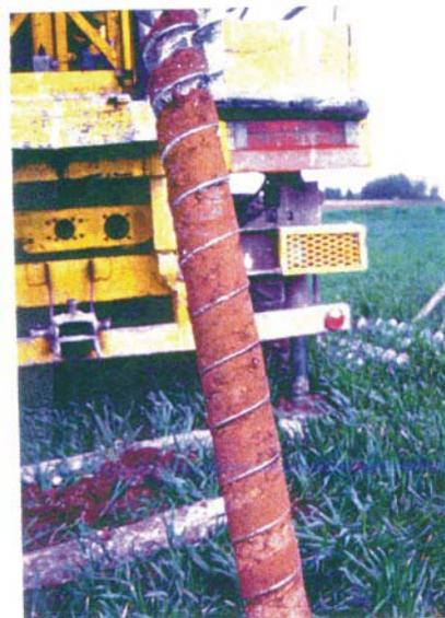
**Figure 10 : Réalisation d'un sondage à la tarière hélicoïdale à sec dans la craie**
