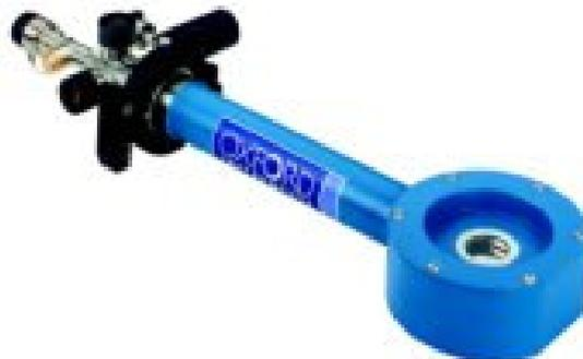
**Figure 19: Vue générale du cryostat MICROSTAT HE**
