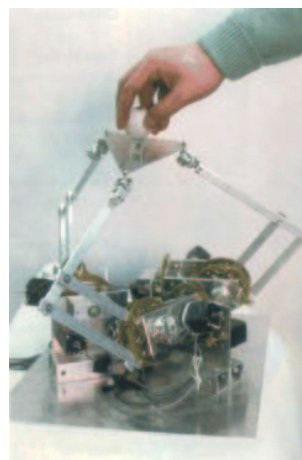
FIG. 1.2 – Le HapticMaster , structure parallèle à 3 ddl actifs
