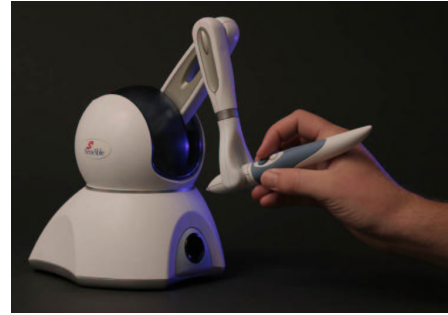
FIG. 1.4 – Le PHAMToM-Omni . Structure mécanique série
