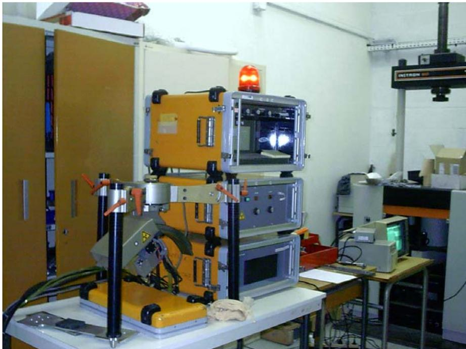
Figure (III.7) : Machine de diffraction des rayons X
