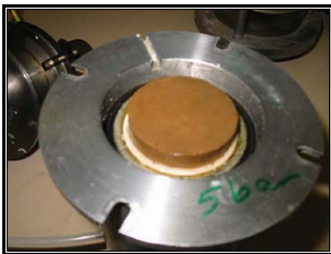
Figure III.10 : Un échantillon préparé pour l'oedomètre à succion contrôlée.
