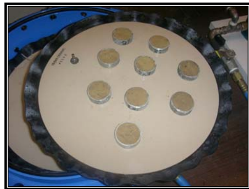
Figure III.11 : Des échantillons préparés pour l'extracteur à pression d'air.
