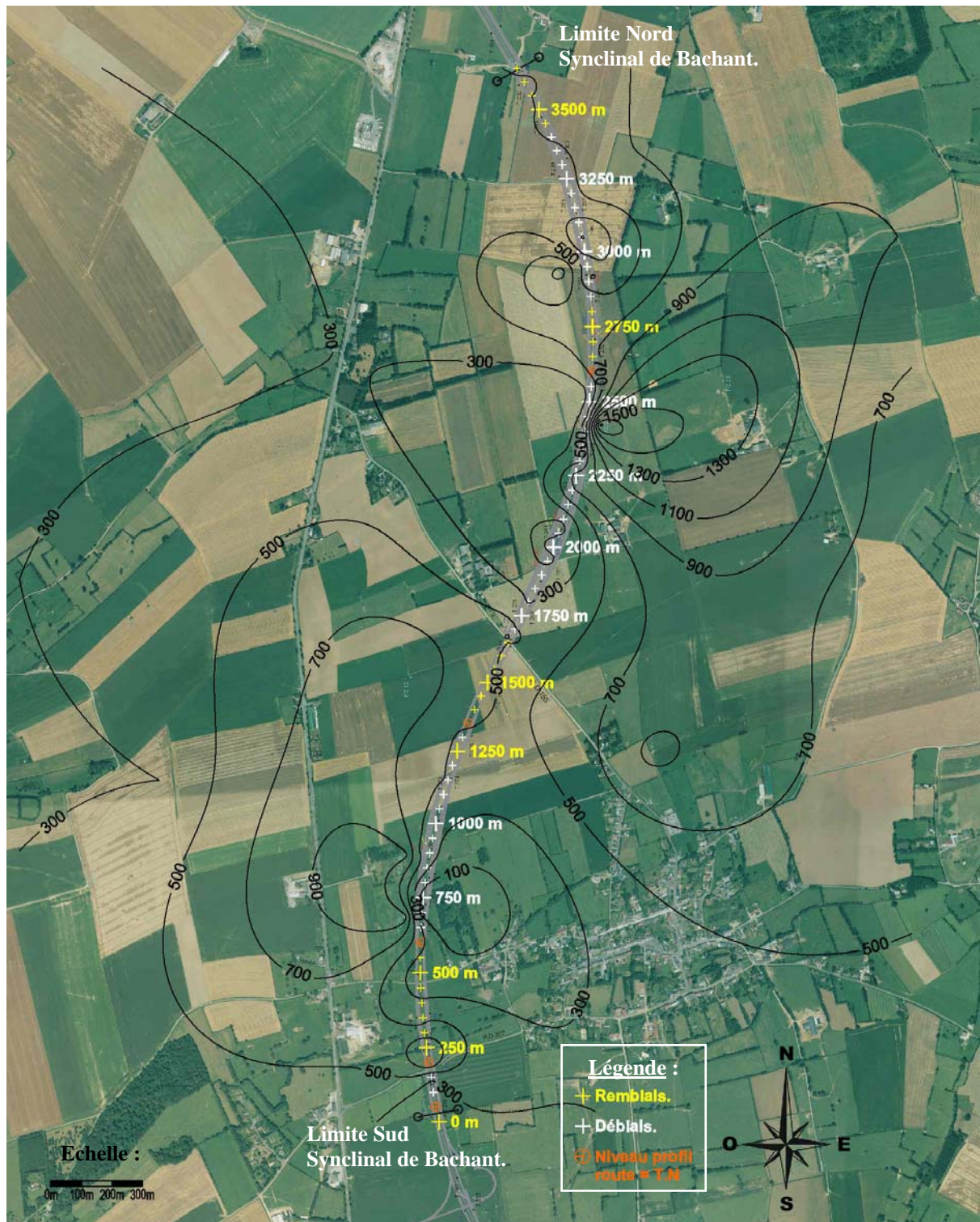
Figure III.3 : Iso-valeurs des épaisseurs de couverture en cm, interpolées à partir des valeurs mesurées dans les différents sondages (Référence : d'après carte RN2, liaisons Avesnes Sud-Maubeuge Sud, opération 21M59A, N° de la pièce 2-2).
