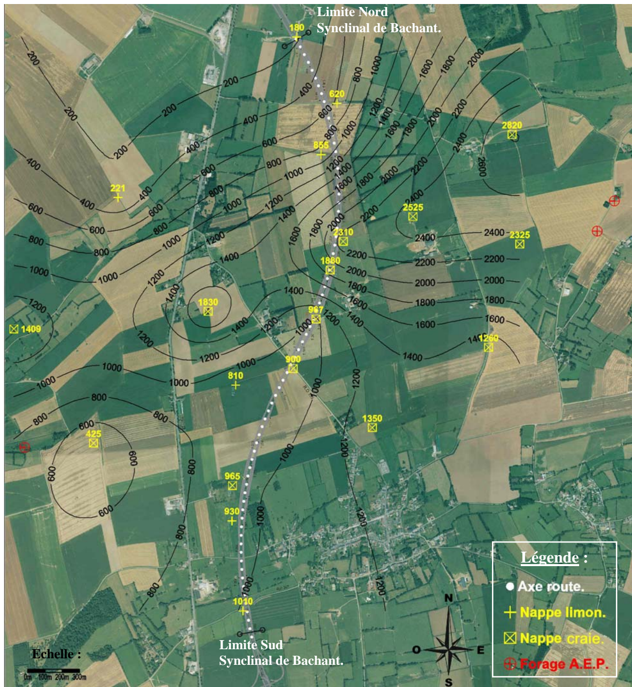
Figure III.4 : Iso-valeurs des profondeurs de la nappe en cm, interpolées à partir des valeurs mesurées grâce aux piézomètres (en jaune) en septembre 2000 (Référence : d'après carte RN2, liaisons Avesnes Sud-Maubeuge Sud, opération 21M59A, N° de la pièce 3-3).
