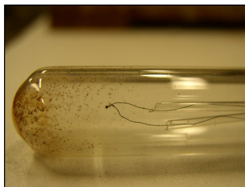
Photo [2.03] - Thermocouple employé pour la mesure de la température dans un tube scellé.
