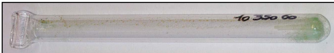
Photographie [2.02] - Représentation à l'échelle 1 d'un tube scellé après scellage et traitement thermique.
