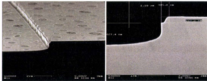
FIG. 4.16 – Test de gravure par RIE sur un substrat de GaAs.
