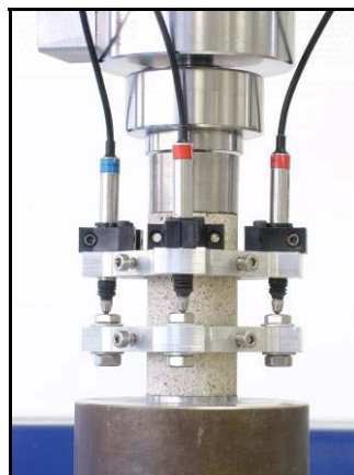
Photo 3-8: colliers, LVDT, capteur de force et échantillon de mortier: mesure du module d'Young.
