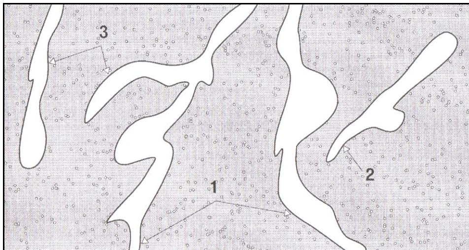
Figure 4-21: représentation schématique d'un solide poreux ([BUIL 1992]). 1: pores interconnectés. 2: pores isolés. 3: bras morts.
