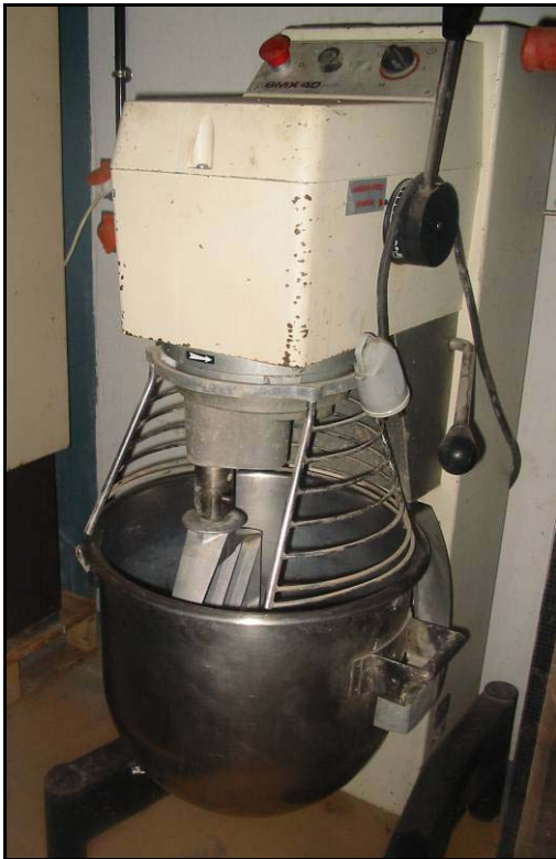
Photo 3-3: malaxeur à vitesse variable pour la confection des mortiers de 2 ème phase.
