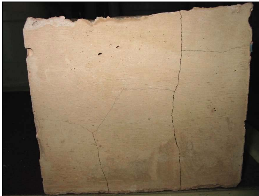
Photo 4-3: apparition de fissures sur une poutre de la formulation MS100* conservée en atmosphère sèche: illustration des désordres provoqués par le retrait de dessiccation.
