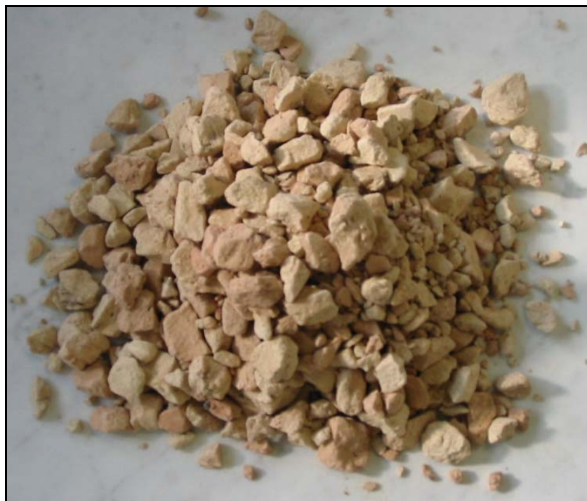
Photo 2-4: vue des sédiments de Dunkerque après traitement (les plus gros grains mesurent 2cm).
