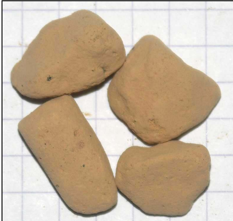
Photo 2-5: vue macroscopique de granulats de sédiments "DFS" traités (graduation: 5mm)
