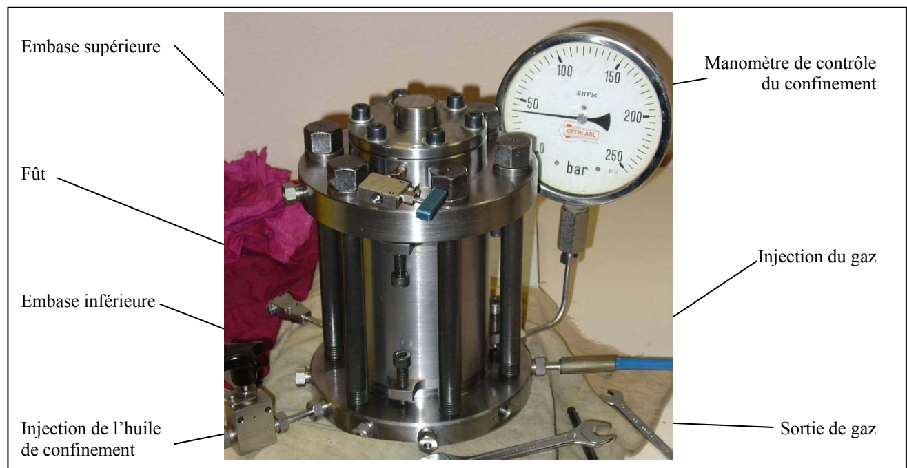
Photo 4-2: cellule hydrostatique de mesure de la perméabilité.
