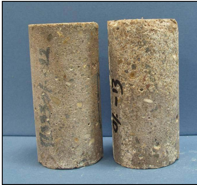
Photo 4-9: dégradation non homogène entre les échantillons (mortier MS33 0/0.315 en marnage)
