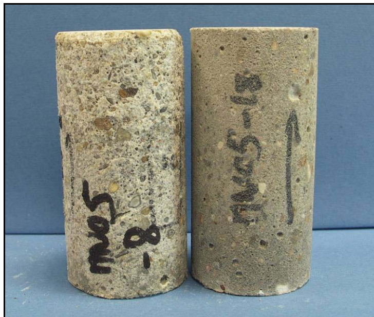
Photo 4-8: dégradation non homogène entre les échantillons (mortier MN05 en marnage)
