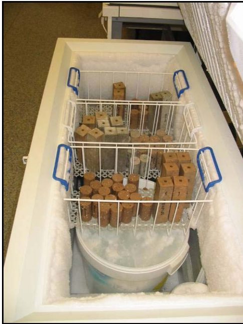
Photo 3-5 : 2 ème phase gel/dégel (air -22°C; eau 20°C ± 2°C)
