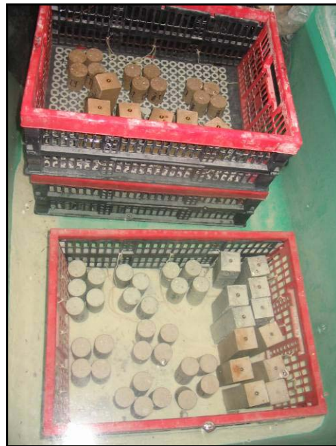
Photo 3-4: échantillons 2 ème phase en cure à l'eau ( 20^{\circ}\text{C} \pm 2^{\circ}\text{C} )
