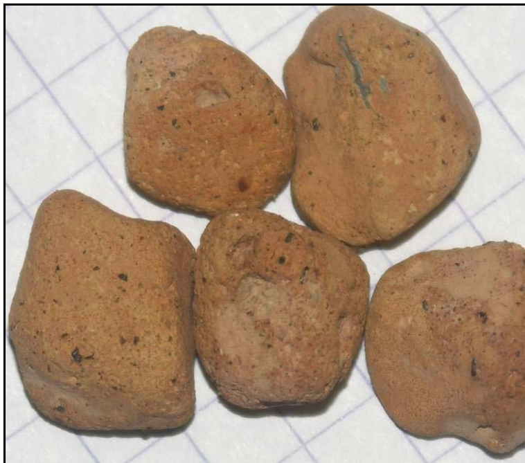
Photo 2-6: vue macroscopique de granulats de sédiments "DFS" traités lavés sur tamis 80µm (graduation: 5mm)
