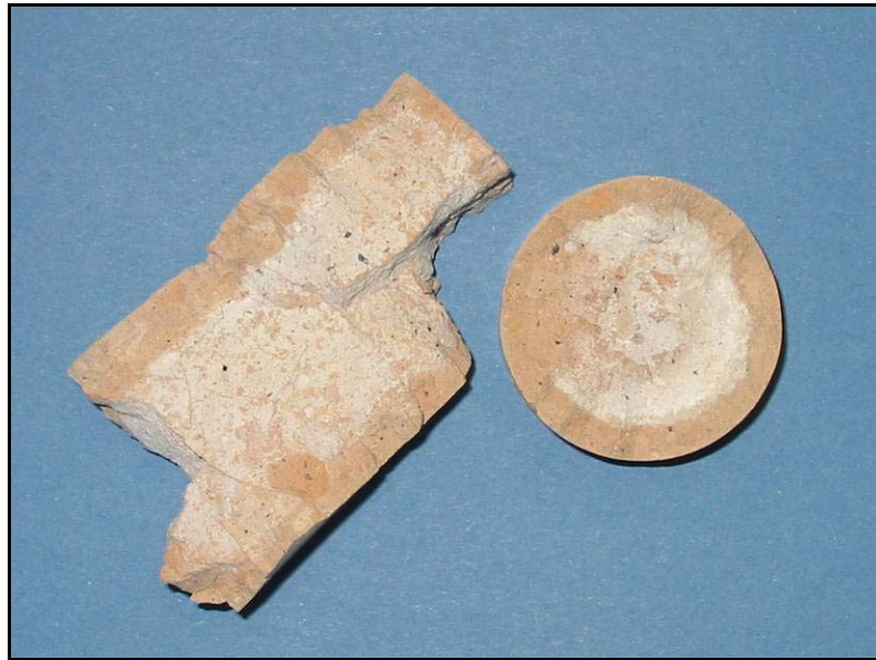
Photo 4-4: distribution des cristaux de sels dans une éprouvette MS100* soumise à des cycles de saturation/désaturation.
