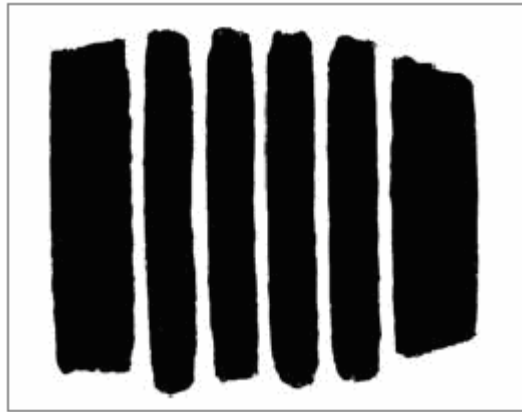
Figure 1.11b : Photo de l'empreinte du pneu super single de Michelin 385/65R22 avec une charge par essieu de 8 tonnes et une pression de gonflage de 800 kPa (Perret, 2003)
