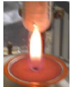
Figure II.3. Flamme de diffusion de méthane
