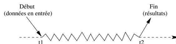
FIG. 3.1 – Exécution d'un système de type transformationnel
