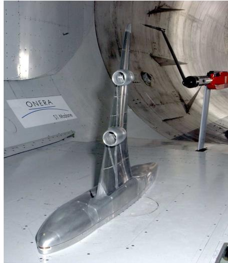
FIG. 7.1 – AXXX - demi-maquette montée dans la soufflerie S1MA.
