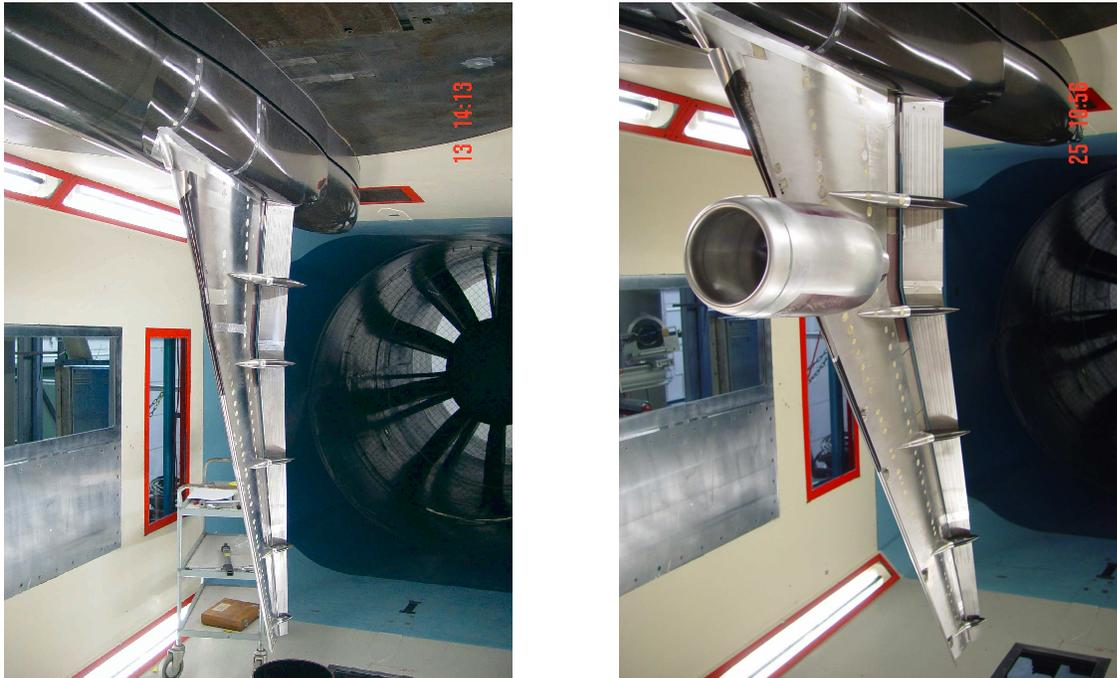
FIG. 6.8 – EUROLIFT2 - Maquette KH3Y avec et sans nacelle dans la soufflerie LSWT.
