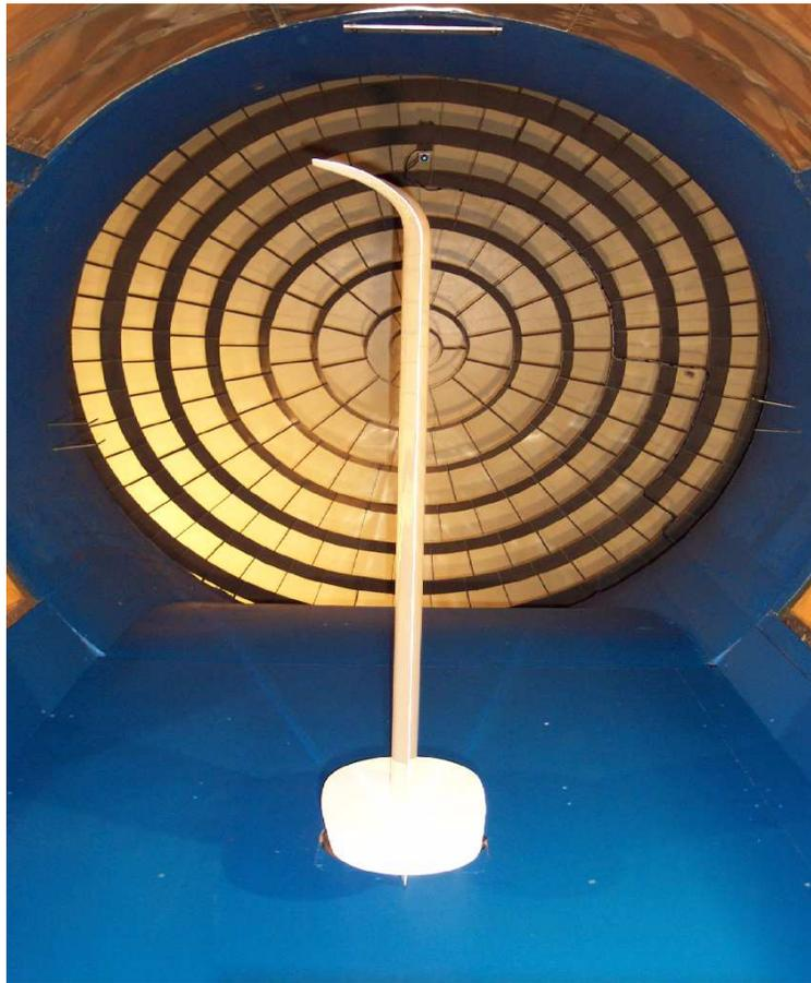
FIG. 6.1 – Dyn'Aéro - Winglet monté dans la soufflerie L1.
