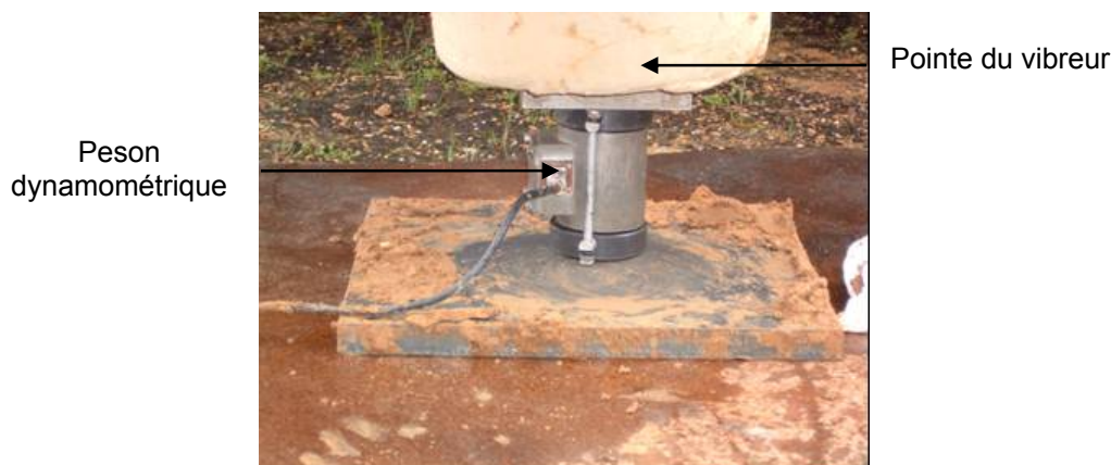
Figure 5-2 – Vibreur en contact avec le peson dynamométrique
