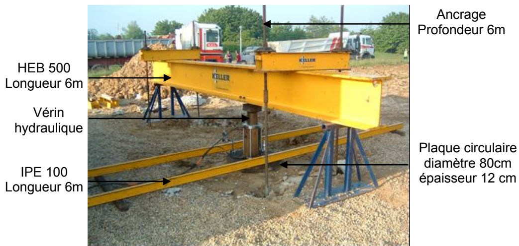
Figure 5-10 – Appareillage de l'essai de chargement
