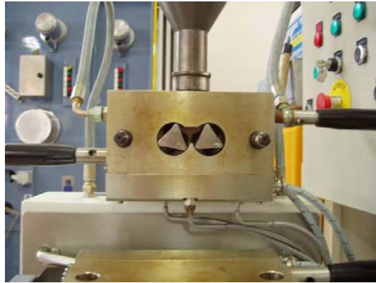
Figure 15 : Malaxeur Thermo Haake utilisé pour les mélanges PLA / 4 % C30B / DOA
