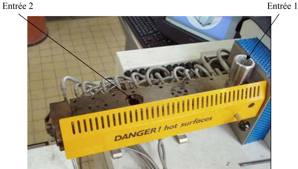
Figure 34 : extrudeuse bi vis corotative avec double entrée
