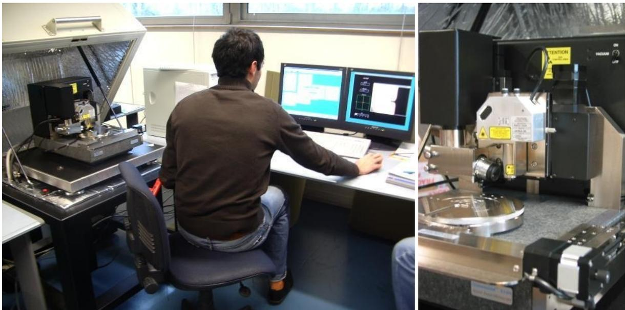
Figure 2.27 : (gauche) Photographie du Dimension 3000 dans son caisson sous flux d'azote ; (droite) photographie du scanner.
