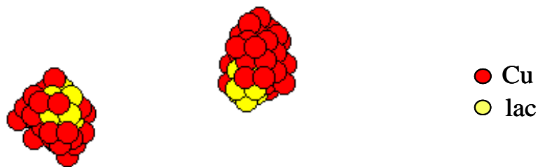
Figure IV-13 : Agrandissement effectué sur les deux complexes lacunes – Cu formés dans l'alliage irradié sous le flux le plus faible.
