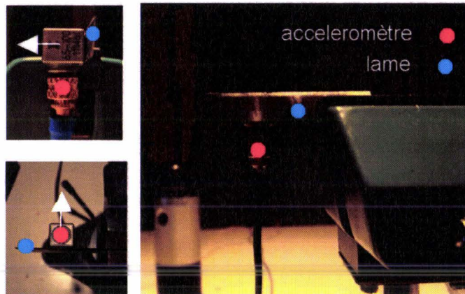
Fig. 4.10 – Schéma du montage de l'accéléromètre sur la lame immobilisée
