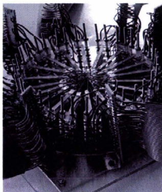
Fig. 6.6 – Afficheur tactile piézoélectrique large bande (20-400Hz)
