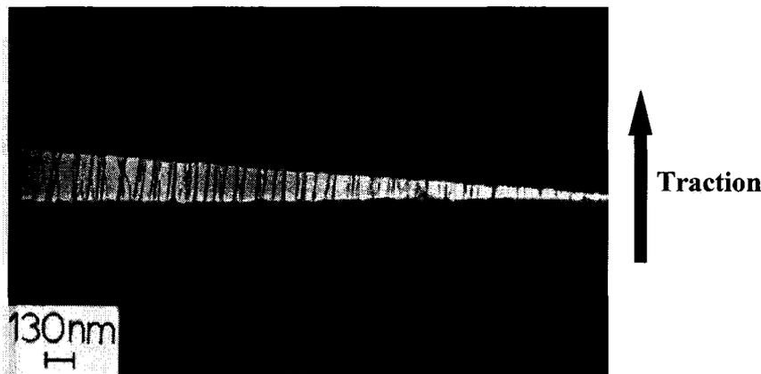
Figure 1.6 : Développement d'une craquelure perpendiculairement à la direction de traction (d'après [www-ics.u-strasbg.fr/sitanex/JIREC2006](http://www-ics.u-strasbg.fr/sitanex/JIREC2006)).
