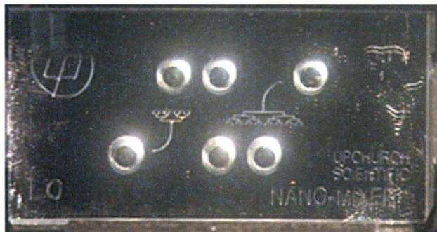
Figure II.13 : Vue agrandie de la puce microfluidique du nanomélangeur
