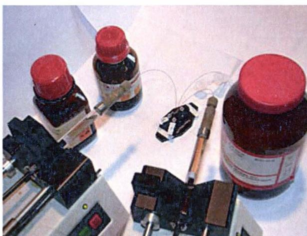
**Figure II.16 :** Photographie du montage avec les deux pousse-seringues qui alimentent le NanoMixer™.
