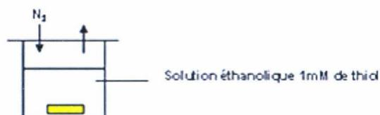
**Figure III.6 :** Protocole d'adsorption.
