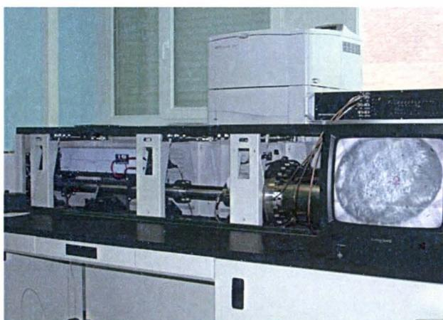
**Figure III.23 :** Appareil MALDI-TOF équipant le centre commun de spectrométrie de masse de l'université Lille I
