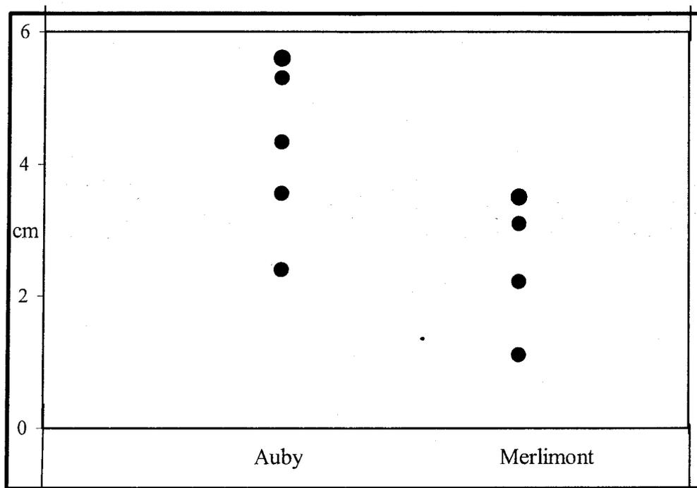
Fig. 63 : Distribution des spots de l'extrait au dichlorométhane du lichen d'Auby et ceux de Merlimont sur une plaque phase inverse ; élution dans le mélange : acétate d'éthyle/toluène/méthanol/eau : 10/30/7/0,6 (V/V)
