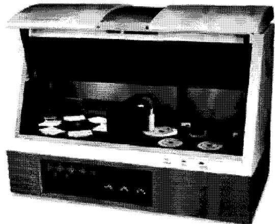
**Figure 1.9 - Laboratoire sur puce réalisé sur CD permettant la centrifugation de volumes calibrés au sein des chambres et l'analyse par fluorescence à l'aide d'un laser : a) vue du micro-système et b) station de travail Gyros Workstation LIF<sup>30</sup>.**
