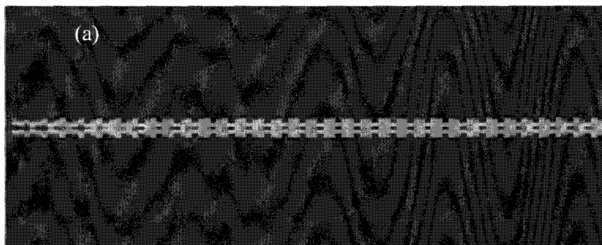
Figure I.17: Illustration de la simulation par BPM-3D de l'injection de la lumière dans un guide de largeur 0,8\mu\text{m} à partir d'une fibre clivée. a) section XZ (Vue de dessus) b) section YZ (Vue en coupe)
