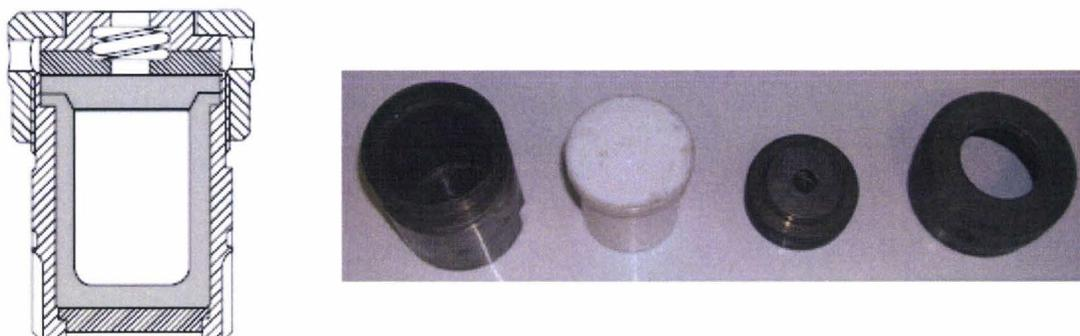
Figure 11: Représentation schématique et photographie d'une bombe de type Parr de contenance 23mL.
