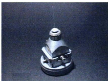
Figure 62. Tête goniométrique de diffractomètre sur monocristal.
