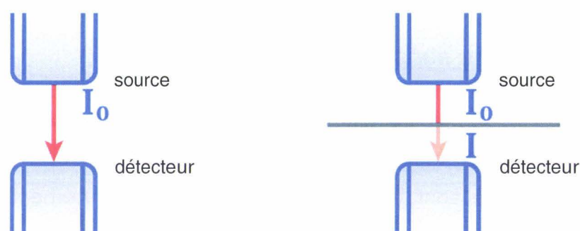
Figure 16 : Principe de la mesure radiométrique
