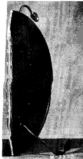
Pile à combustible utilisée pour le projet Apollo (1965-1975) (Pratt and Whitney)
