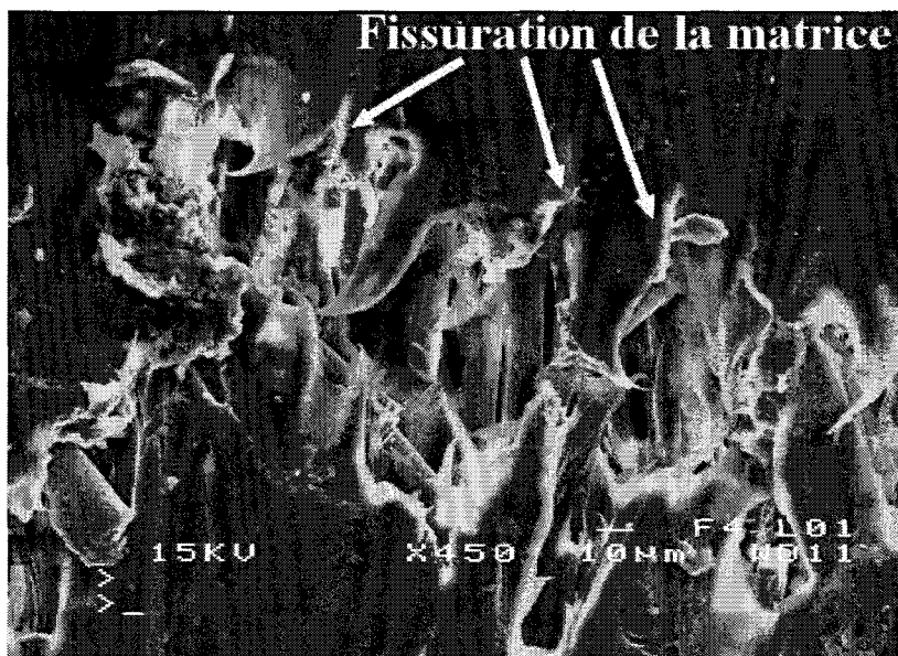
Figure III.16 Fissuration de la matrice dans le PA66-15%
