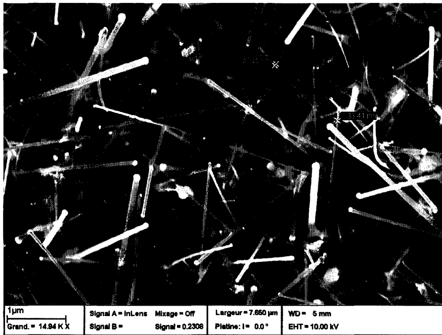
Figure 25 : Image MEB de nanofils de silicium obtenus sur une surface de silicium (111) à 500°C montrant l'effet de la température et les différentes orientations des nanofils.
