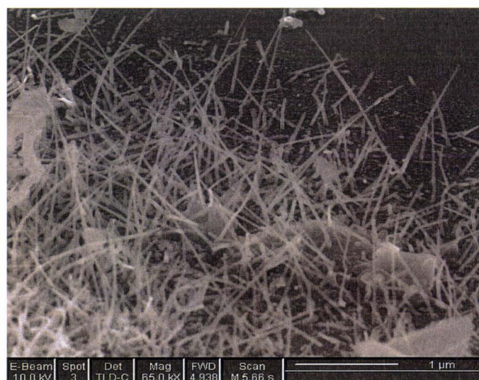
Figure 9 : Image MEB de nanofils de silicium obtenus par la méthode VLS.
