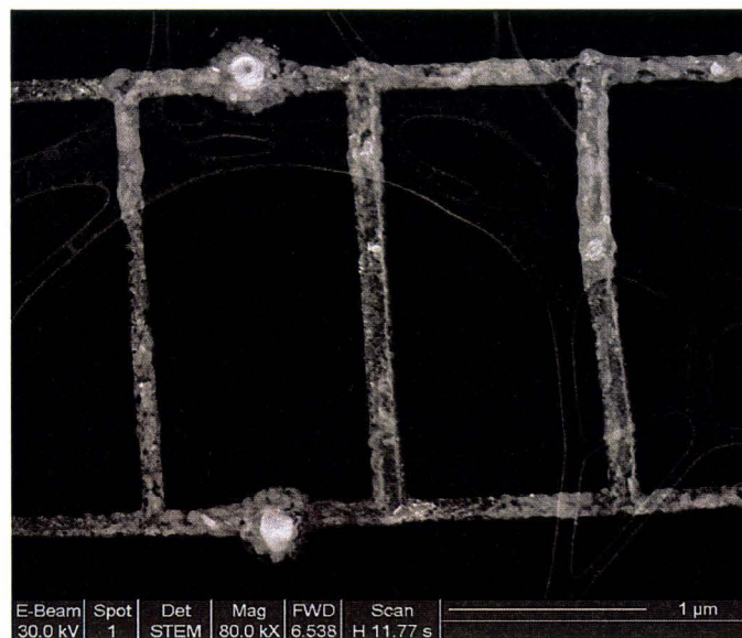
Figure 19 : Image MEB (vue dessus) d'une structure en forme d'échelle après un recuit à 700^\circ C pendant une minute.
