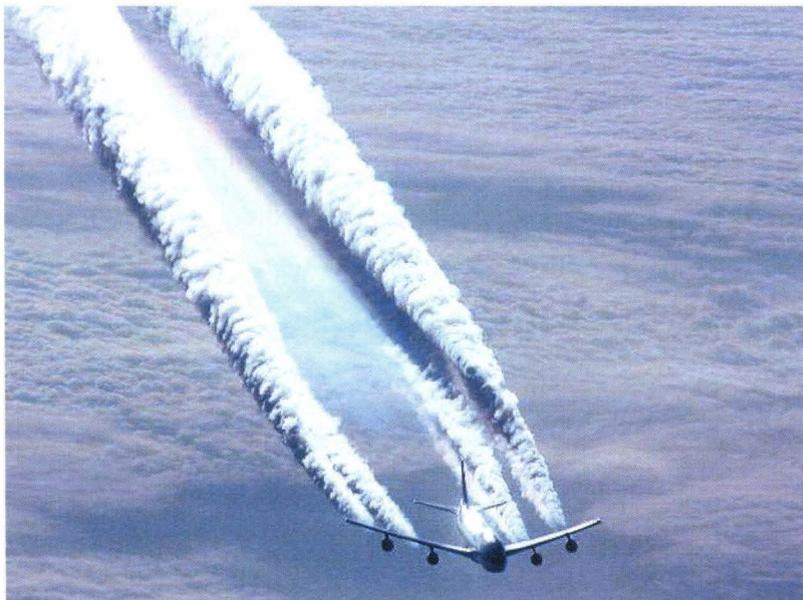
Figure 1.3 : Traînée d'une Boeing 747.
