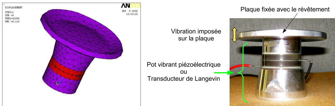
FIG. 2.3 – Résultat de l'analyse modale effectuée sous ANSYS : à 41 kHz le disque à un mode 4 radial. A droite : la réalisation du dispositif de caractérisation.
