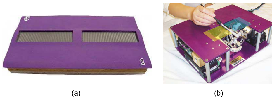
FIG. 4.5 – (a) Les deux textures réelles en acier inoxydable à comparer, (b) Le dispositif à retour de force à 3 ddl utilisé pour simuler les textures (d'après [TAT + 06]).
