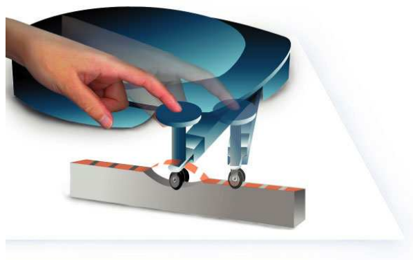
FIG. 1.11 – Dispositif permettant de créer l'illusion de trous et de bosses (d'après [GRDLT]).
