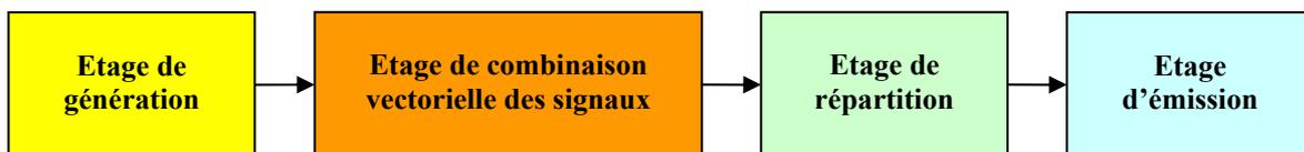
Figure II. 2 : Schéma bloc de la balise
