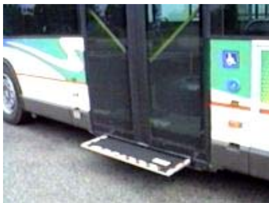
Photo 2-14 : Structure d'un bus dotée d'une rampe d'accès rétractable faisant le lien entre le trottoir et le plancher du bus. [SWC.II 14]
