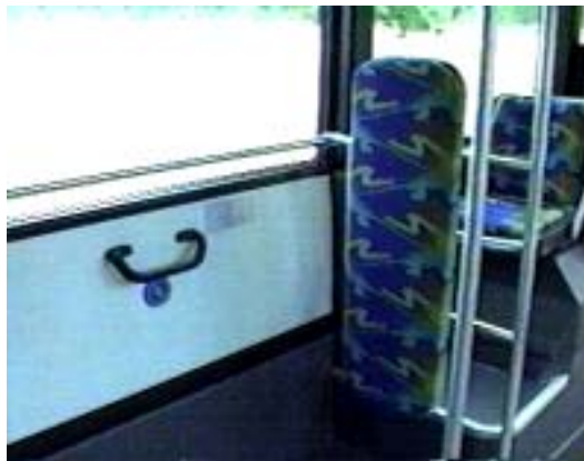
Photo 2-16 : Emplacement spécifique réservé au fauteuil roulant. Un bouton spécifique "arrêt demandé" est disposé à portée de main de l'utilisateur. [SWC.II 16]
