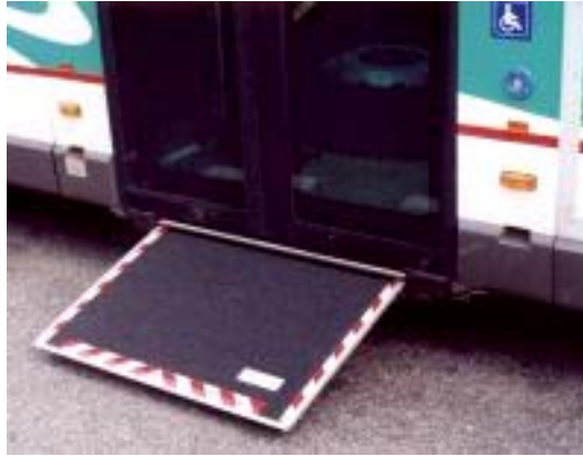
Photo 2-15 : Palette sortie actionnée par le conducteur progressivement. [SWC.II 15]
