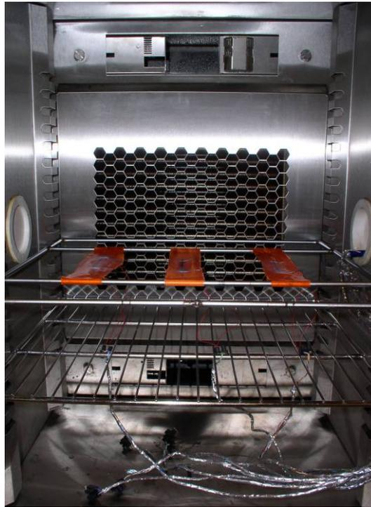
**Figure III.13** : Eprouvettes équipées de capteurs et placées au centre de l'enceinte climatique
