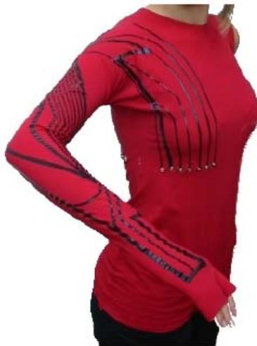
**Figure I.10** : Partie d'un vêtement équipé de capteurs [18]
