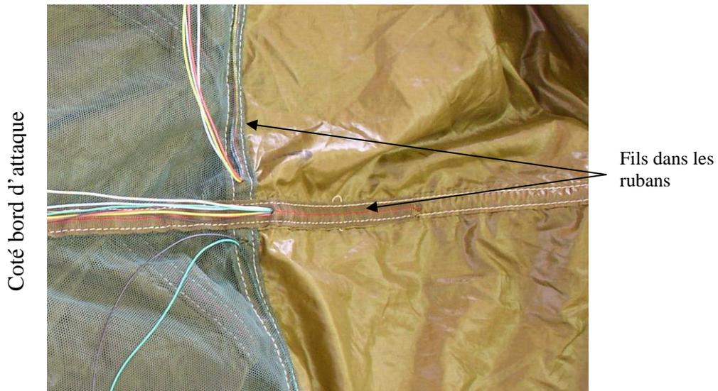
*Figure IV.9 : Passage des fils dans les rubans, sortie côté bord d'attaque*
