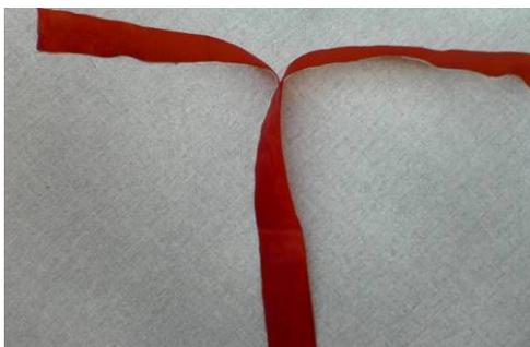
**Figure III.2 : Eprouvette de test de pelage**
