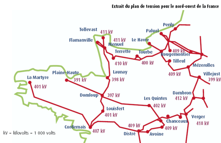
Fig. 2.21. Exemple de plan de tension et de points pilotes [RTE02].
