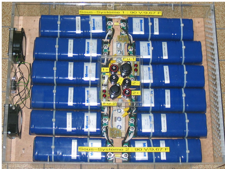
Figure 16. Banc de supercondensateur de la plate forme expérimentale SMM
