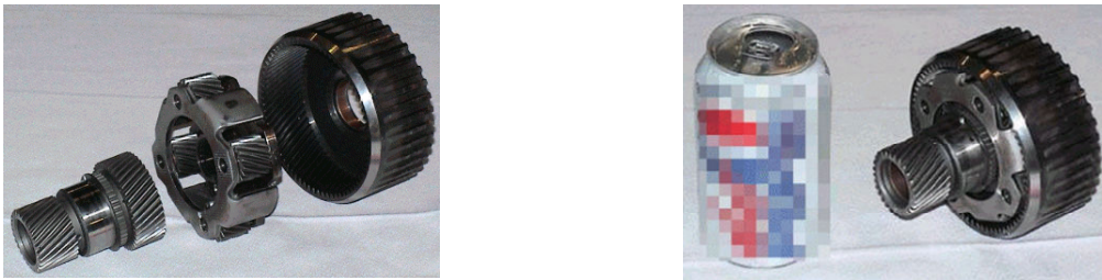
Figure 2-38. Train planétaire simple de la Toyota Prius [ROBY 07]
