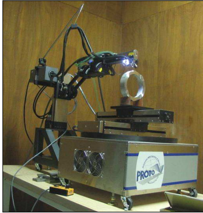
Figure II.3 : machine de diffraction de rayons X « Proto-iXRD »
