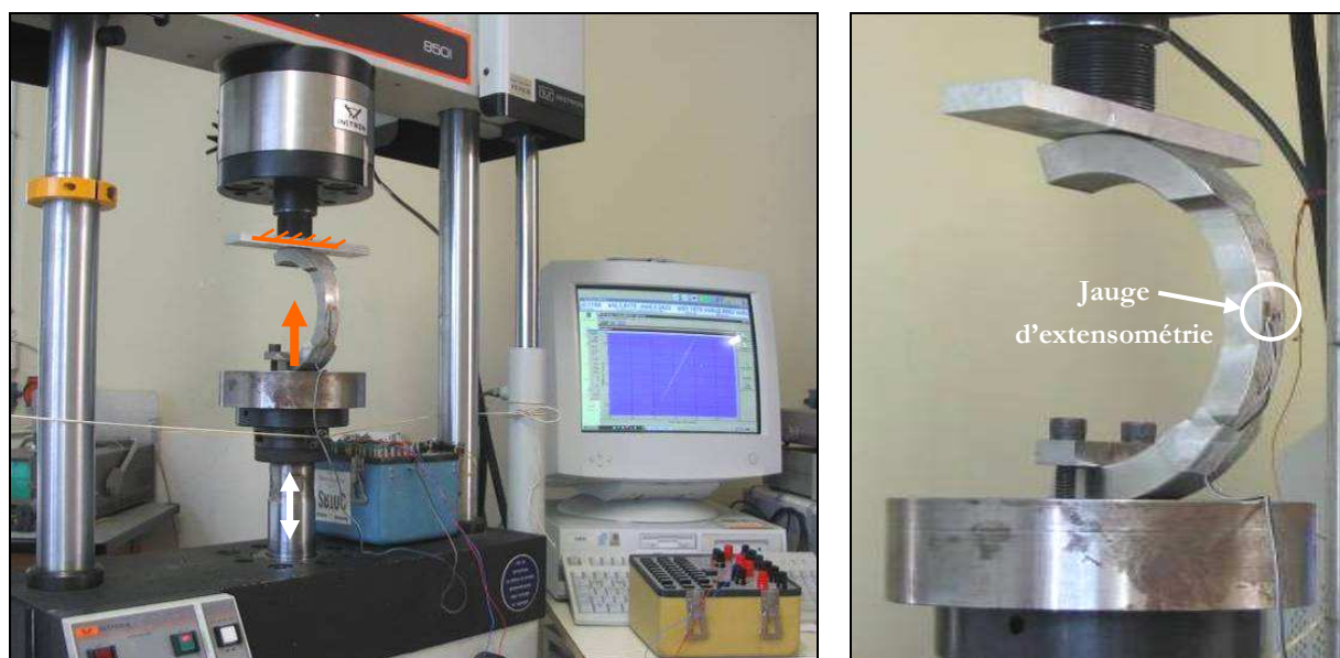
Figure II.16 : montage d'essai de fatigue
