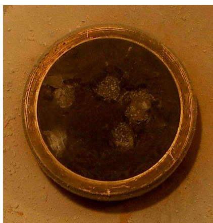
Figure 3.15 – Nettoyage d'une surface de glace polluée par des suies obtenue par désorption sélective à l'aide d'un rayonnement visible 532 nm (d'après [Mihehan, 2005b])
