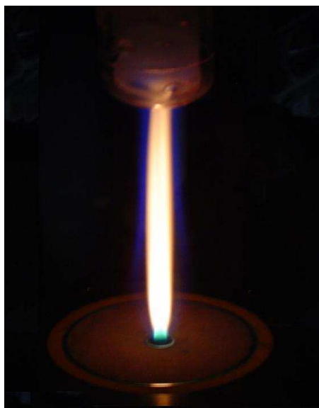
Figure 5.7 – Photographie de la flamme de prémélange acétylène/air de richesse 2,9 (d'après [Bouvier, 2006])
