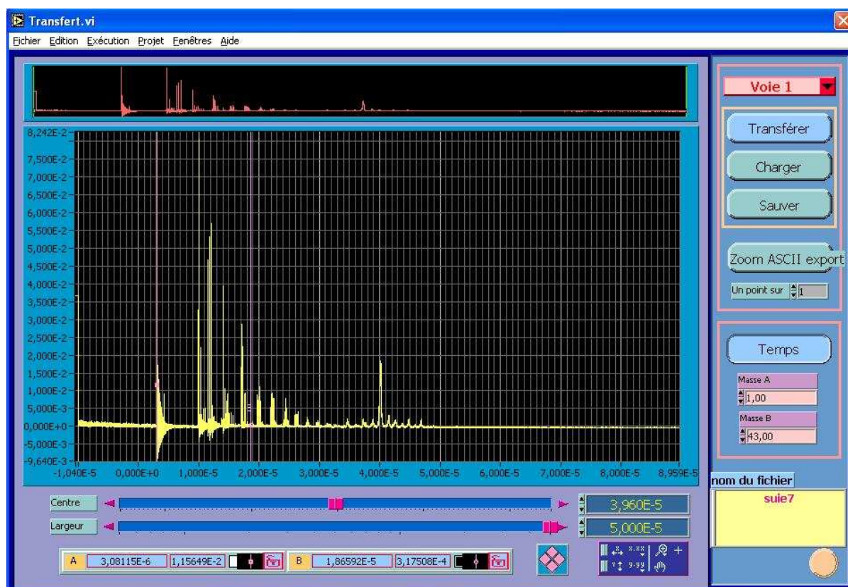
Figure 2.15 – Ecran de contrôle et d'acquisition pendant une expérience typique d'analyse d'un échantillon des suies
