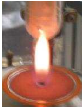
Figure 5.5 – Photo de la flamme de diffusion de méthane
