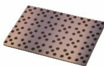
Figure 64 : Photo d'une plaque DIOS, avec, en noir, les points de silicium poreux sur une plaque de silicium cristallin. [DIOS target plate with the black dots corresponding to porous silicon, on a crystalline silicon plate]
