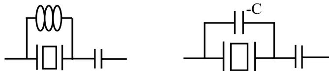
**FIGURE 2.16. Cellule d'accord en fréquence permettant de régler les fréquences série et parallèle d'un résonateur.**
