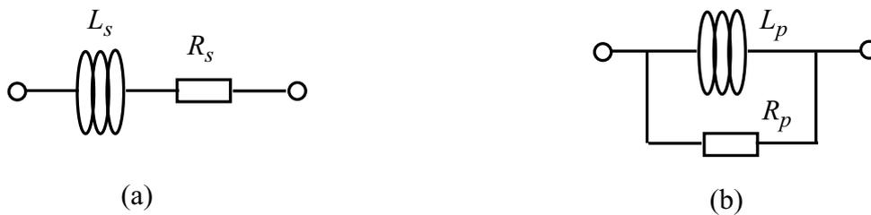
**FIGURE 3.15. Equivalence entre 2 modèles d'inductance.**
