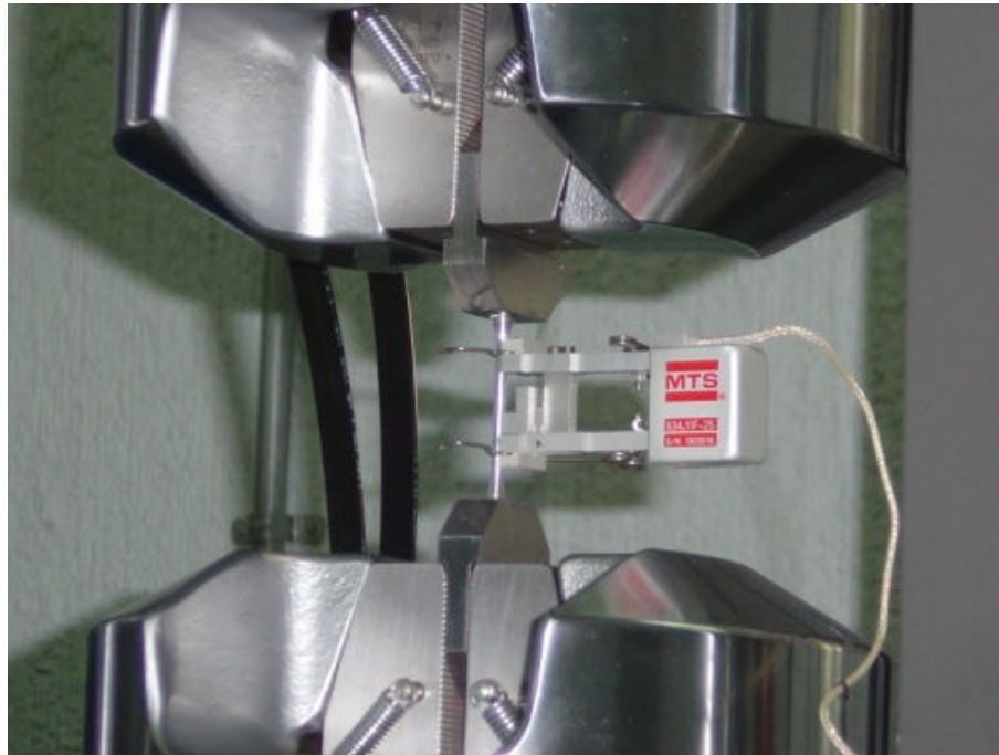
Figure 1.20 Essais à amplitude de déformation imposée, extensomètre à lames.
