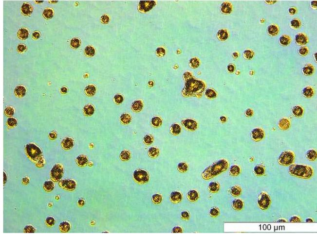
figure 3.5 : Image par microscopie optique (grandissement x 20) de la surface de l'échantillon aec1320 obtenue avec un rapport V/III = 900. Mise en évidence de la démixtion de phase détectée par diffraction X
