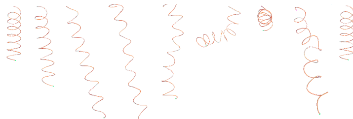
Fig. II.14 – Déformations successives d'un ressort soumis à plusieurs contraintes.
