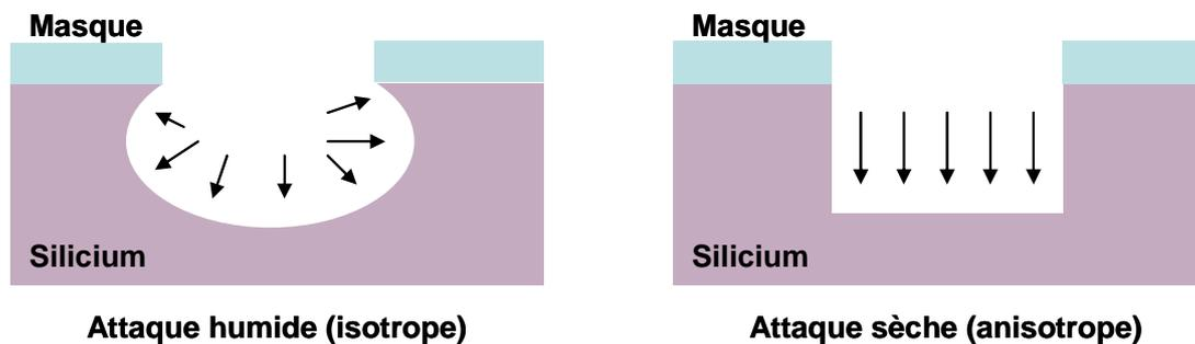
**Figure 3. 21: Profil de gravure du silicium par voie humide ou sèche.**
