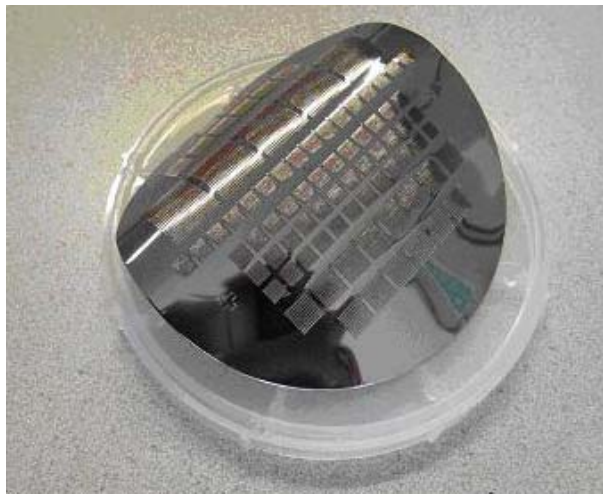
Figure 11 : Photographie d'un wafer déformé par la contrainte liée à l'oxydation du poreux
