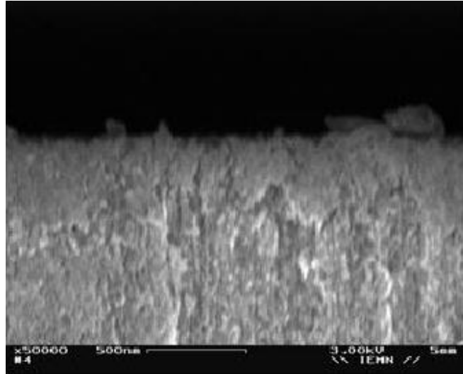
Figure 11 : Photographie au MEB d'une couche de Si-poreux à 60%
