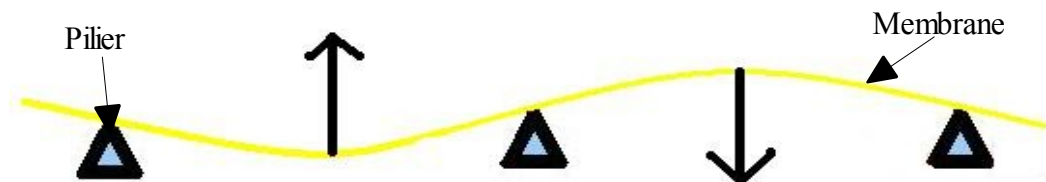
fig. 48 : Illustration du couple de force de rappel de la structure
