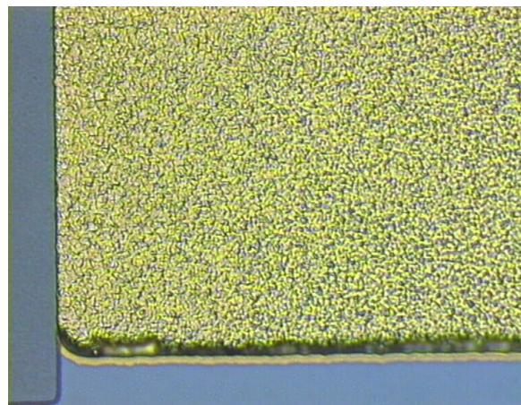
fig. 96 : Bourrelets d'électrolyse dans les sous-gravures
