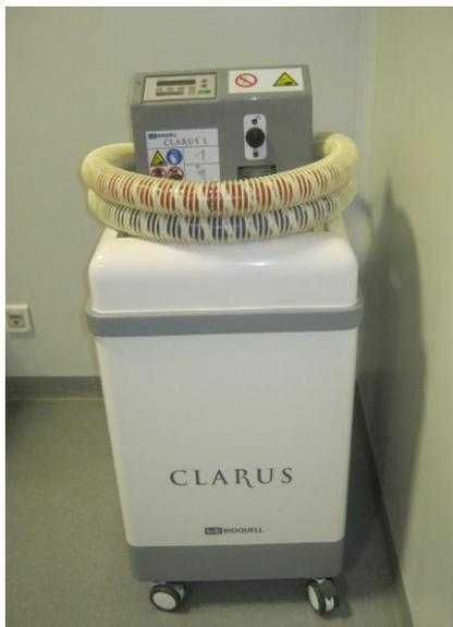
**Figure 19 : Générateur de peroxyde d'hydrogène**
