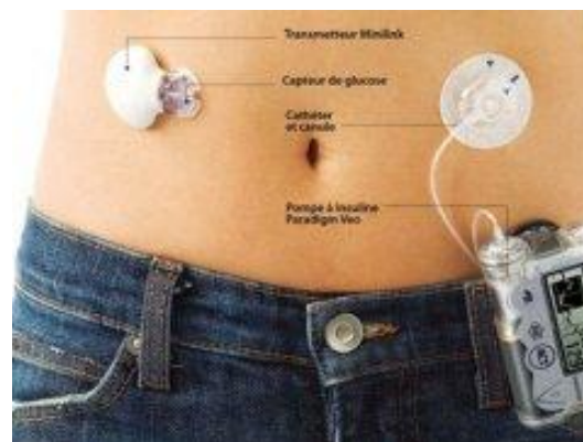
Schéma 13 : Pompe à insuline couplée à un capteur de glucose
