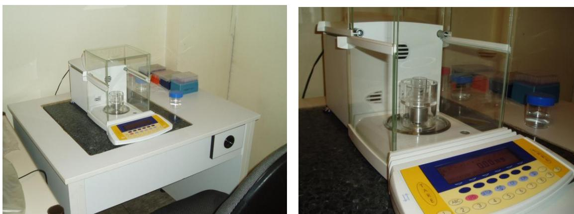
Figure 13 : Dispositif de pesée pour la vérification des pipettes automatiques
