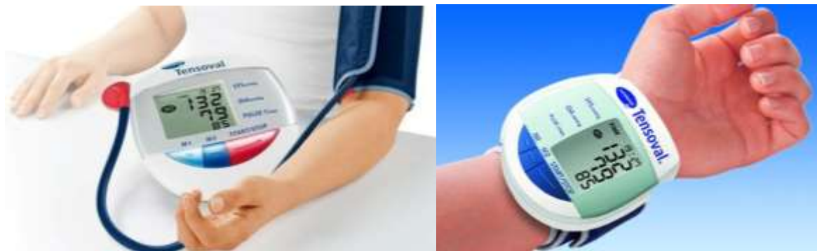
Figure 7 : Illustration de deux types d'autotensiomètres utilisant la méthode oscillométrique
