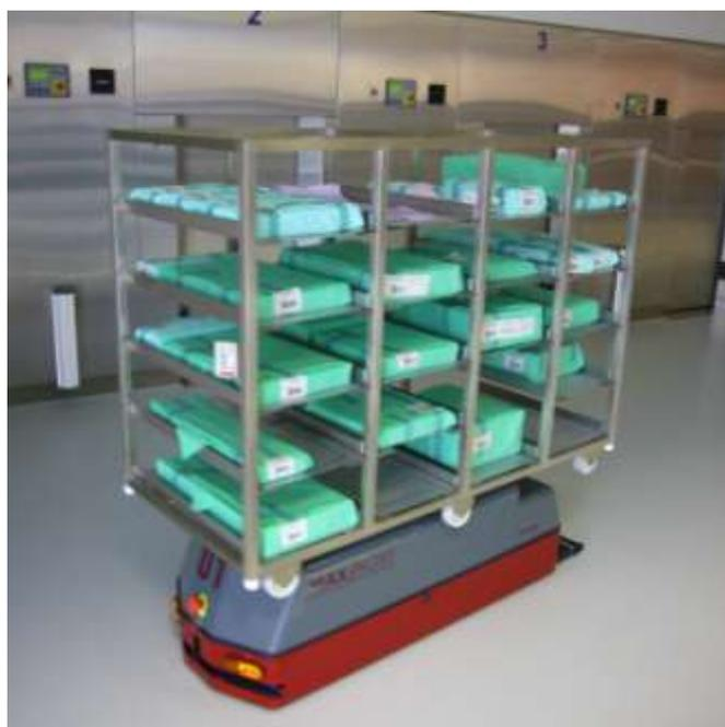
**Figure 3 : AGV transportant des PO.**
