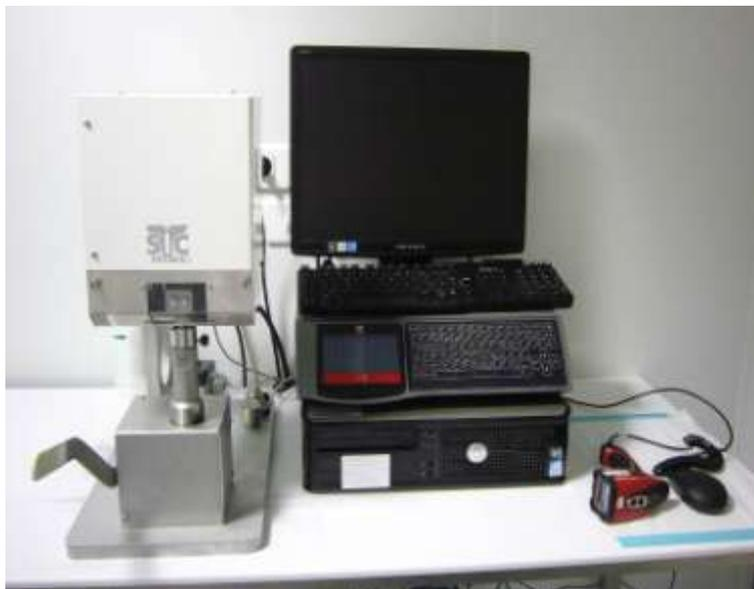
**Figure 6 : Appareil de gravage Sic Marking®.**
