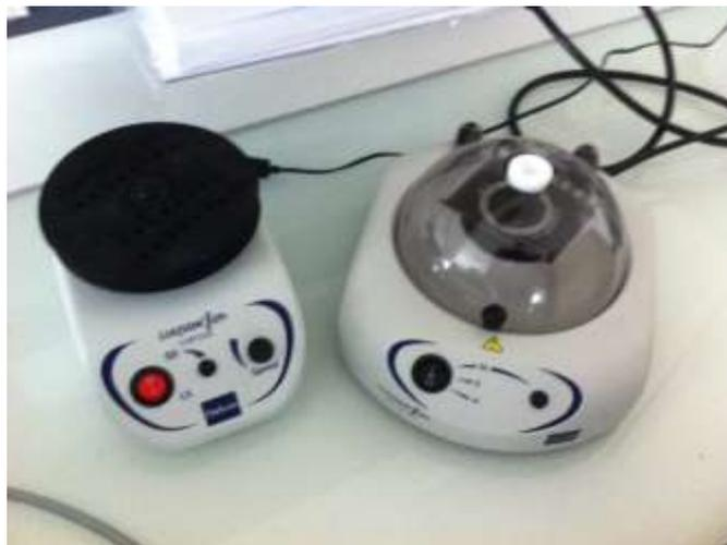
**Figure 35: vortexeur et centrifugeuse pour les barrettes de puits**
