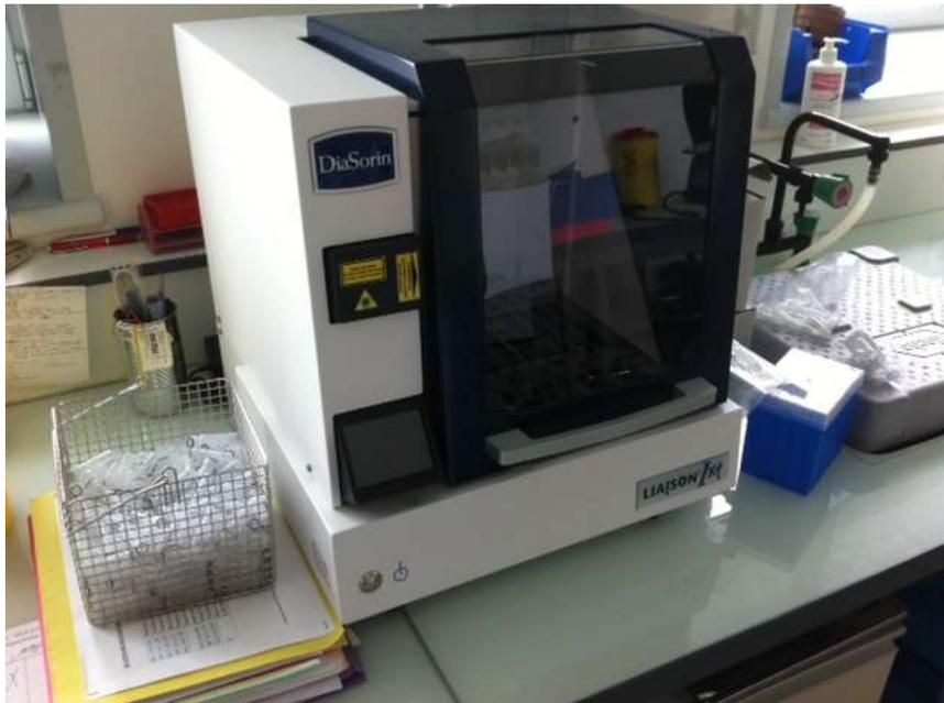
**Figure 27: Extracteur automatisé *LIAISON® Ixt***
